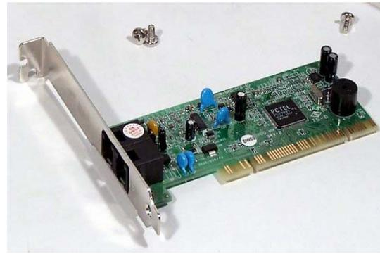
والمودم **Modem** هو اختصار للكلمة **Modulator /Demodulator Device** ، ويوجد نوعين من المودم ، حيث يوجد نوع داخلي مثله مثل الكروت ويوضع على اللوحة الأم **Mother Board** ، والنوع الآخر خارجي ، ولكل نوع مميزاته ، راجع الشكل السابق للتوضيح .
